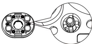
2. スポンジヘッドを取り出して、シリコンヘッドをスロットに合わせて締めてください。
