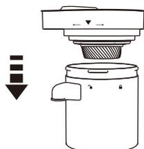
4. 逆時計回りに蓋を回して、完全に密閉されていることを確認してください。
