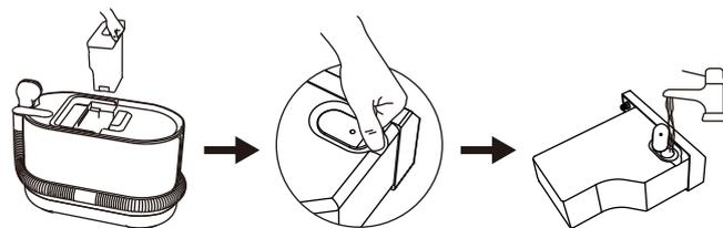
2. 清水タンクを取り出し、ハンドルを引き上げ、専用ソープボックスを取り出し、注ぎ入れます。
