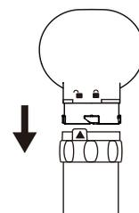
3. 反時計回りに、締め付けリングを回転させ、完全にしまったことを確認してください。
