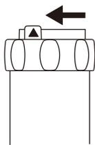
2. シャワーヘッドのロック解除の矢印を解除位置に合わせて、ブラシヘッドをハンドルに挿入します。
