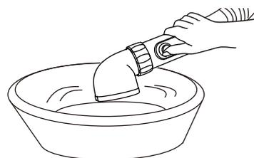
3. 水道水を洗面器に1L程度注ぎ、メンテナンススイッチを押して水道水を吸引し、除菌水を洗い流してください。
