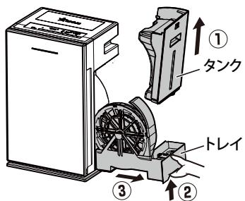
3. 除菌水フィルターセットを取り出し、トレイの水を排水する
