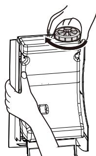
※キャップの溝とタンクのねじ山が噛み合うようにしっかりと締めてください。
