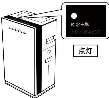
トレイ内の水がなくなると、お知らせ音とともに給水ランプが点灯し、次亜塩素酸水の生成が止まり、「空気清浄」運転に切り替わります。
